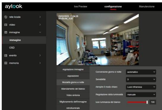
**Automatico:** cambia la visualizzazione a colori o in bianco e nero in automatico, inoltre tramite il cursore **Luminosità della luce** è possibile impostare il valore degli illuminatori IR.
